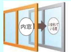
窓の断熱改修工事
