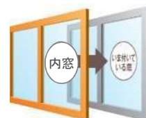
窓の断熱改修工事
